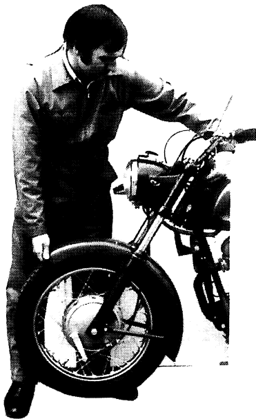
Fig. 1 KONTROLLE DES STEUERKOPFLAGER-SPIELES CONTROLE DU JEU DANS LA TETE DE DIRECTION
